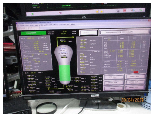
ภาพที่ 2-19 ระบบตรวจวัดค่าอุณหภูมิและความดันในถังปฏิกรณ์
