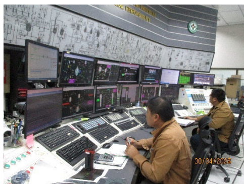
ภาพที่ 2-20 ลักษณะแผงควบคุมการทำงานของเครื่องจักร และระบบควบคุมการผลิต
